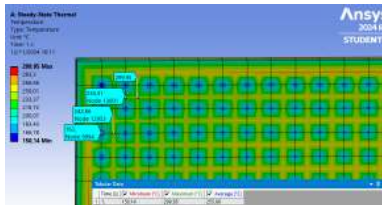
Gambar 4.7 Hasil pemanasan material Inti PTFE di suhu 400°C pada Aluminium Composite Panel (ACP)
